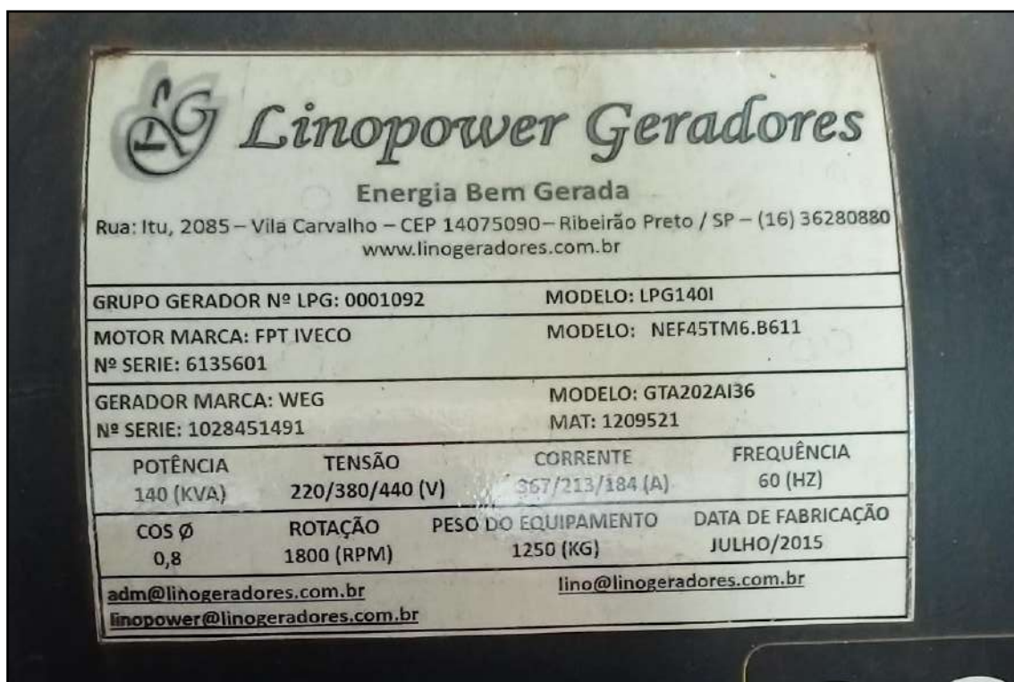
ITEM 0061 - GERADOR DE ENERGIA - 140KVA - 220/380/440V
